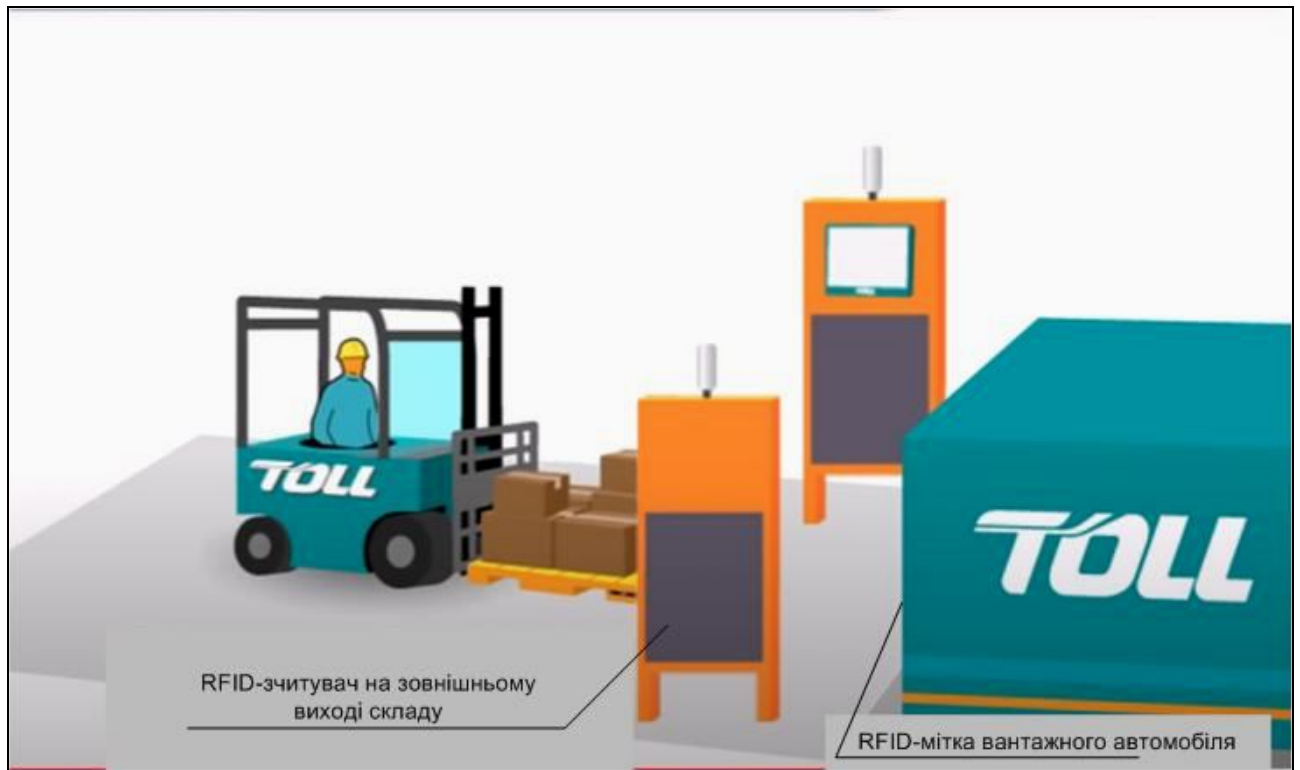
Рисунок 4.18 – Автоматична фіксація готової продукції, що вивозяться зі складу, та контроль завантаження її у автомобіль
