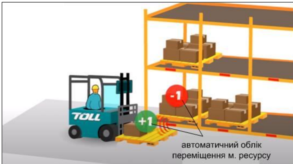
Рисунок 4.17 – Автоматичне зчитування та обробка інформації про переміщення матеріального ресурсу
