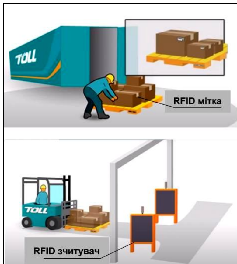
Рисунок 4.15 – Зчитування RFID-міток з палет при прийомці матеріальних ресурсів від зовнішніх постачальників
