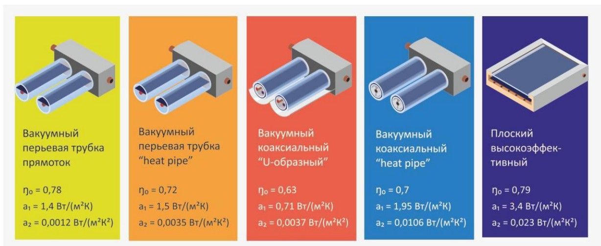
Рисунок 1.13 - Основні типи вакуумних трубчастих колекторів.
