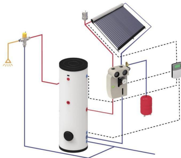
Рисунок 2.7.- Система гарячого водопостачання.
