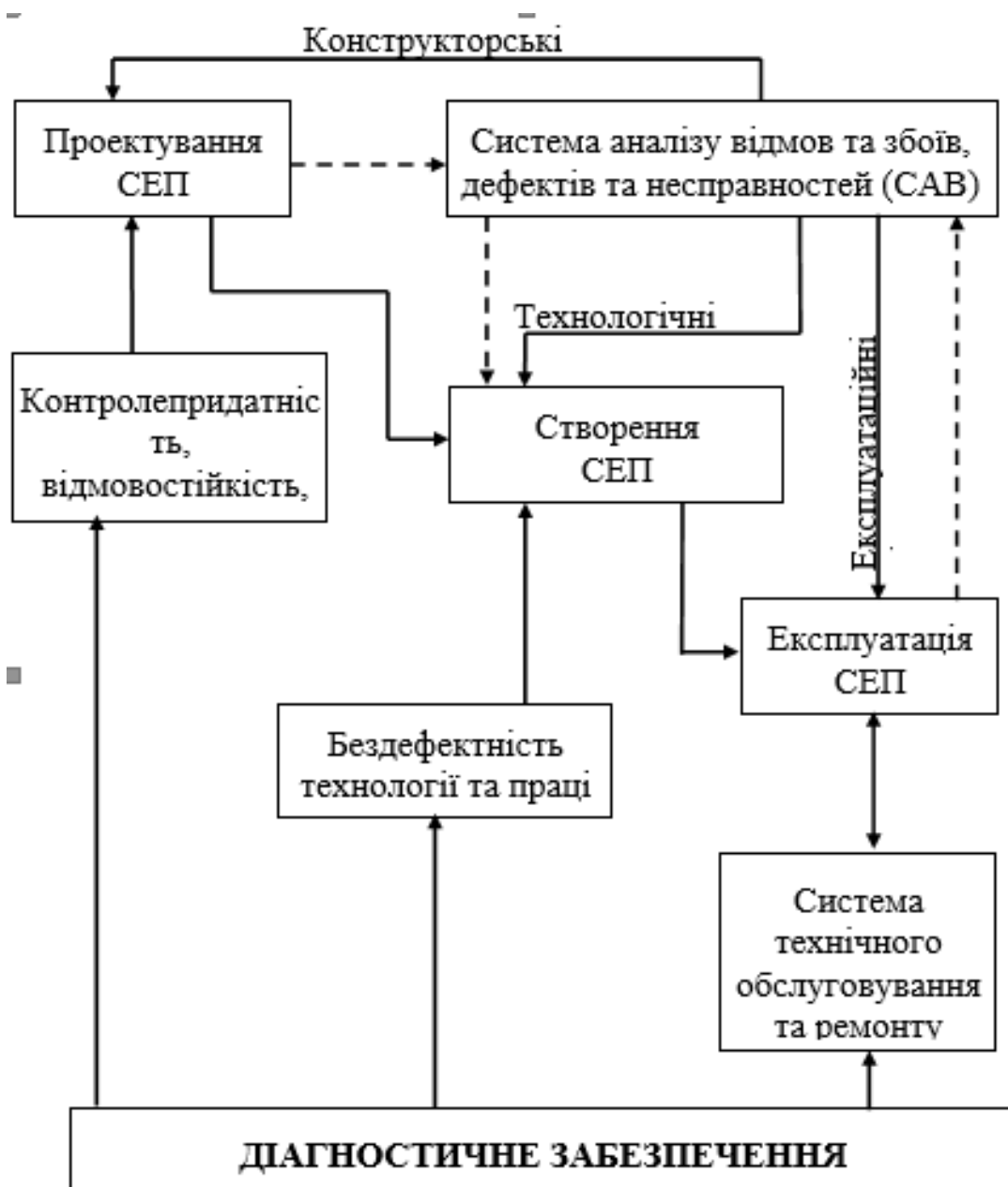
Рисунок 1.1 – Життєвий цикл СЕС та показ на концептуальному рівні застосування технічної діагностики, в забезпеченні їх якості та надійності
