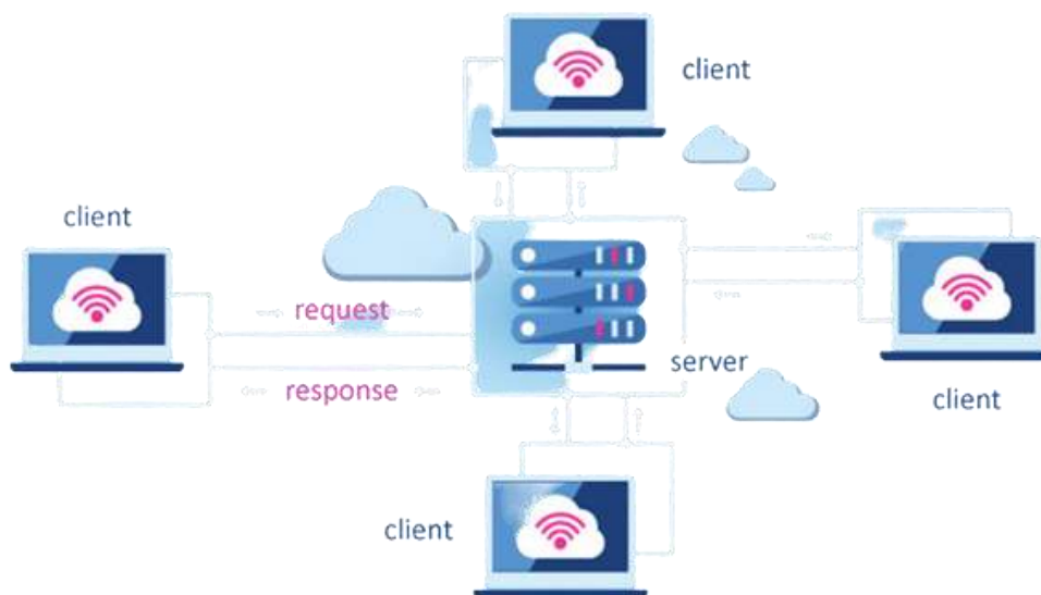
Рисунок 3.1 – Схема подання «клієнт-серверної» архітектури
