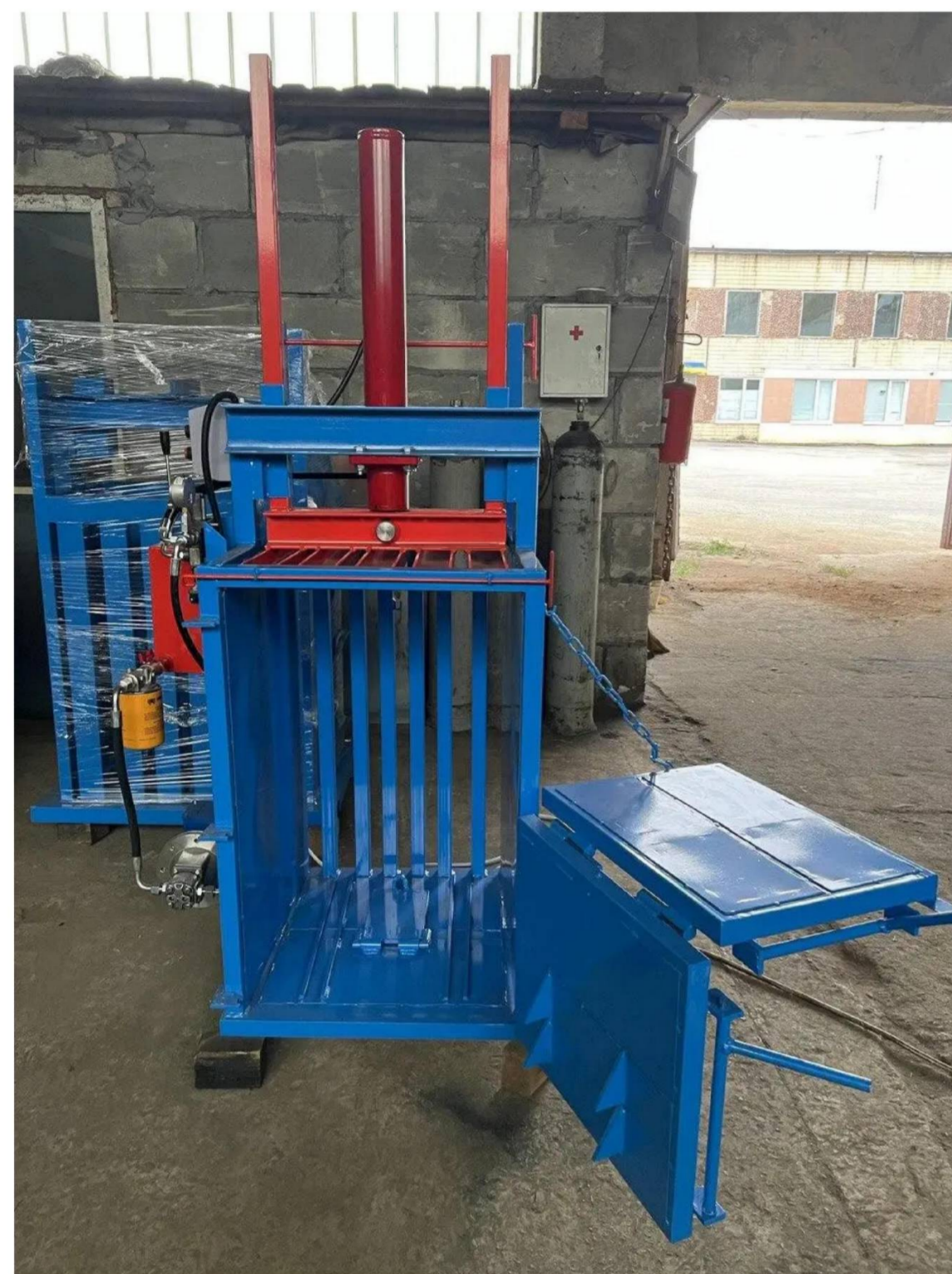
Рисунок 2 – Прес для відходів вторинної сировини "ПГ-5"
