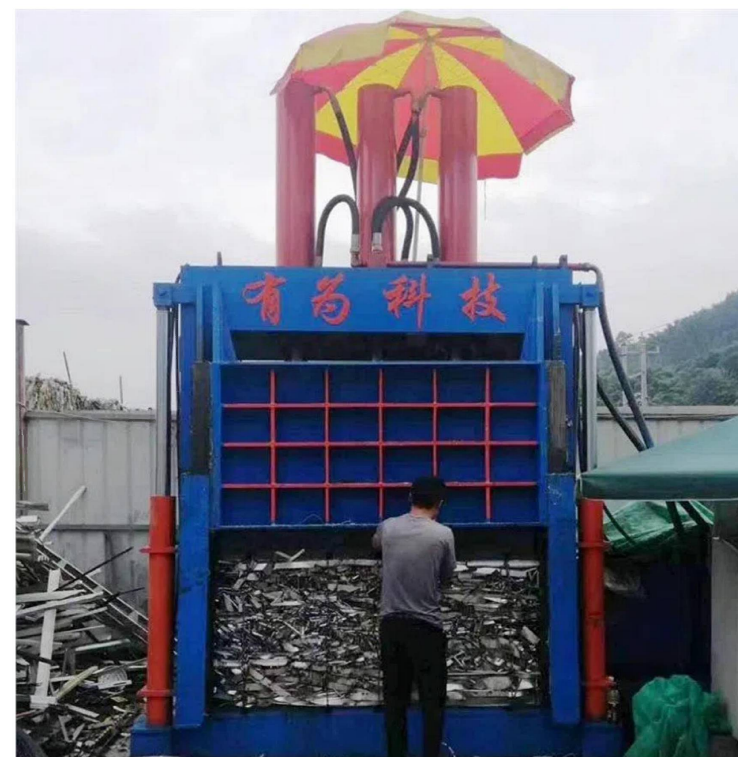
Рисунок 5 – Вертикальний прес –підбирач для металів відходів FWL-120M
