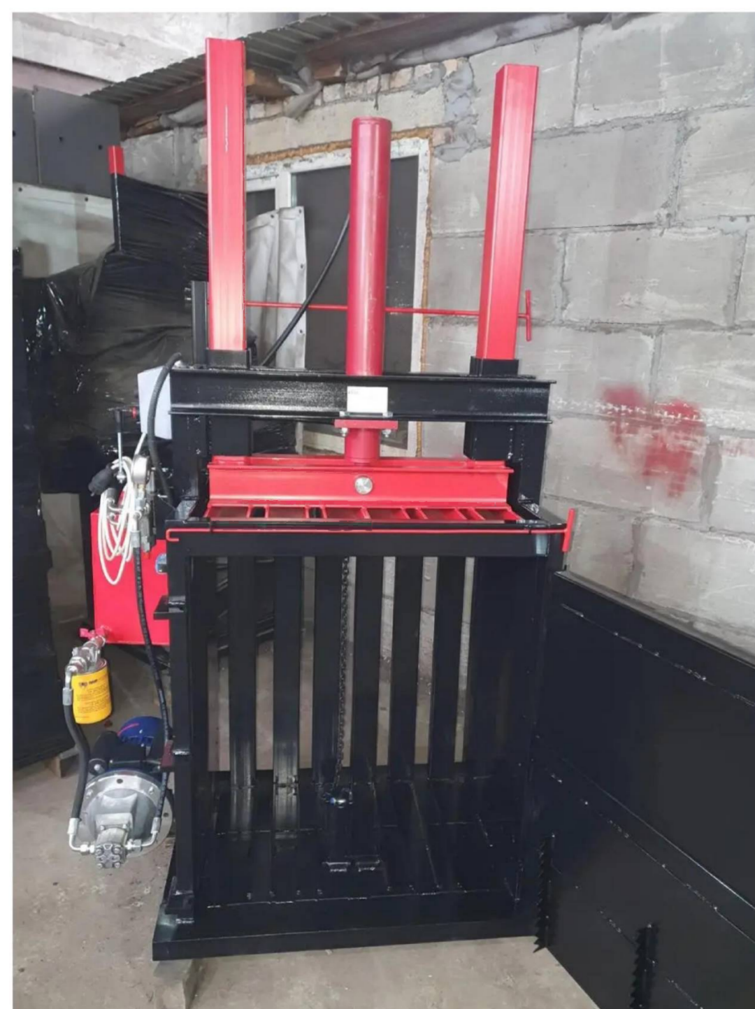
Рисунок 2 – Прес для відходів вторинної сировини "ПГ-5"
