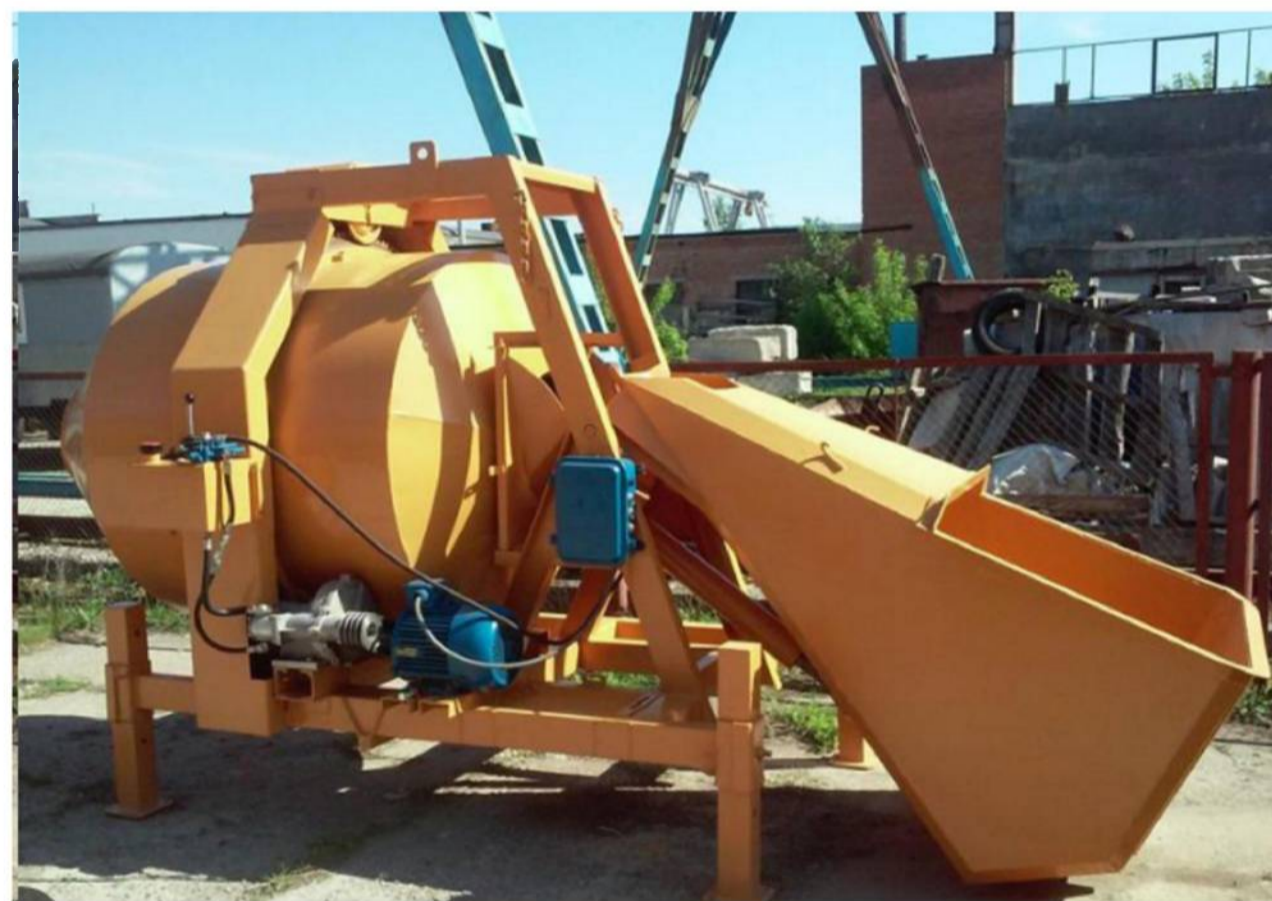
а) загальний вигляд; б) – схема конструкції Рисунок 1 – Пересувний бетономішувач.
