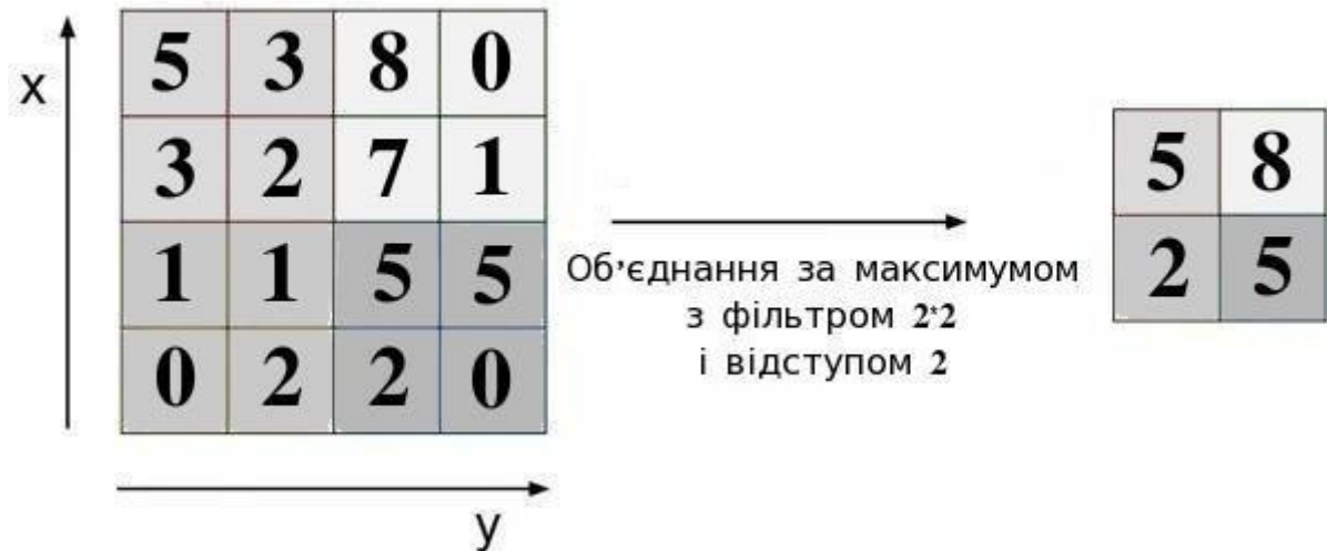
Рисунок 2.14 – Об'єднання за принципом «максимум»
