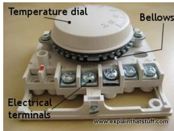
Рисунок 1.3 – Механічний термостат побудований на основі газонаповнених сільфонів
