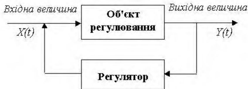
Рисунок 1.1 - Структурна схема типового автоматичного регулювання
