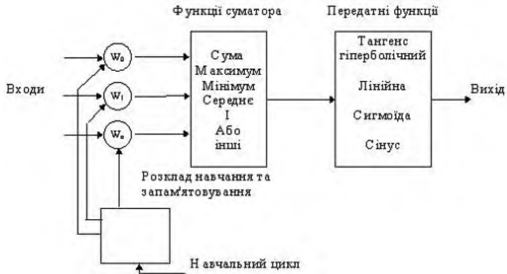
Рисунок 2.4 - Модель «елемента обробки»
