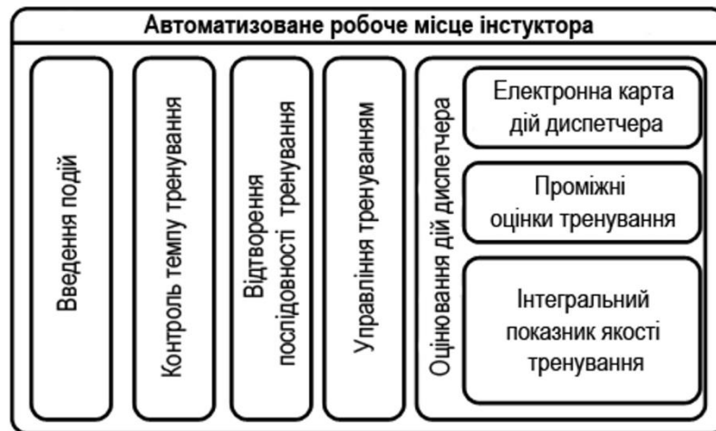
Рис. 2.3. Складові блоки автоматизованого робочого місця інструктора
