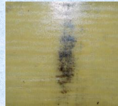
Рисунок 8.2 – Сліди перегріву на текстолітовому кільці внаслідок замкнення магнітного шунта на пресуючу плиту
