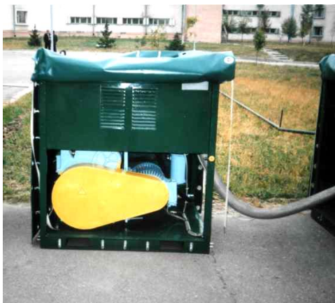
Рисунок 1.4 – Обладнання для ремонту шунтуючих реакторів: а- цеолітова установка для обробки масла; б – вакуумний блок для сушки ізоляції
