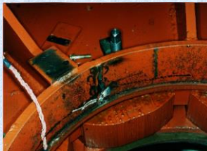
Рисунок 8.1 – Перегрів внаслідок замкнень електромагнітного екрану на пресуючу плиту
