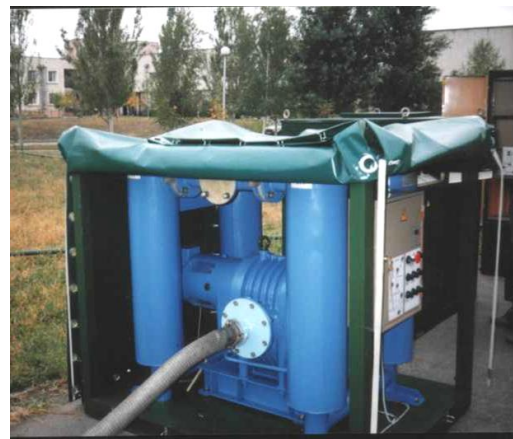
Рисунок 1.4 – Обладнання для ремонту шунтуючих реакторів: а- цеолітова установка для обробки масла; б – вакуумний блок для сушки ізоляції
