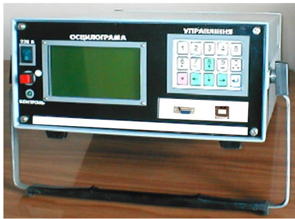
Рисунок 4.2 – Зовнішній вигляд розробленого пристрою для контролю часових характеристик реле
