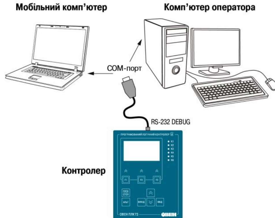
Рисунок 4 – Варіант підключення до ПК для програмування контролера через порт RS-232 DEBUG
