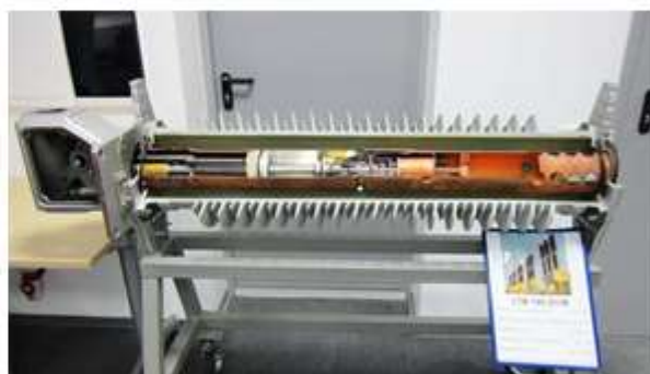
Розріз полюсу вимикача LTB145
