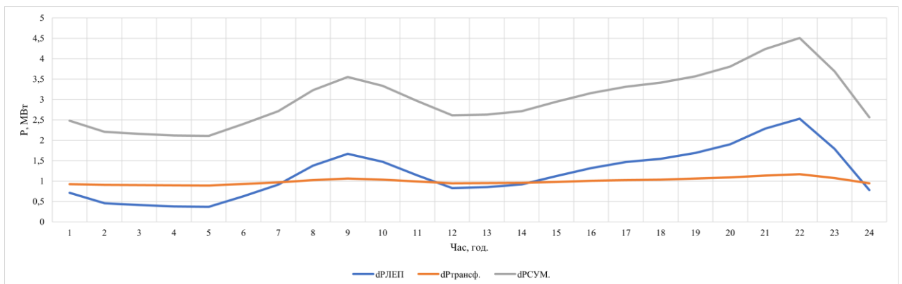
Рисунок 3.19 - Результати оцінки втрат електроенергії в мережах за типовими графіками навантаження та генерації (наведені графіки змін втрат у лініях електропередачі, трансформаторах та загальні втрати)
