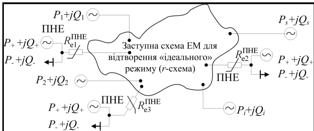
Рисунок 2.1-. Заступна схема електромережі для розрахунку ідеального струморозподілу за рентабельністю приєднання накопичувачів енергії
