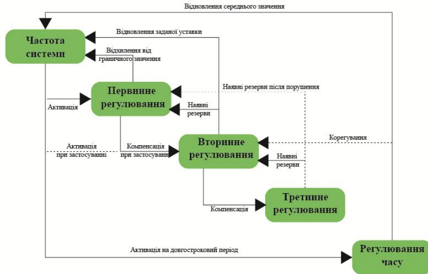
Рисунок 1.9 – Функціональна схема системи регулювання частоти та потужності в енергосистемі
