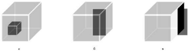
Рисунок 26 – Основні елементи принципу трансформації відкриття та закриття: а – елементи внутрішньої фурнітури (меблі); б – елемент перегородки; в – елемент фасаду
