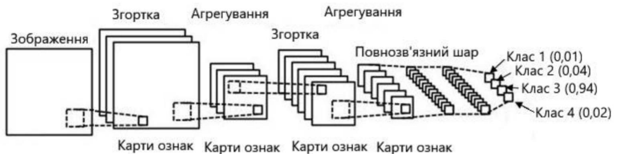
Рисунок 2.3 — Загальний вигляд згорткової нейронної мережі
