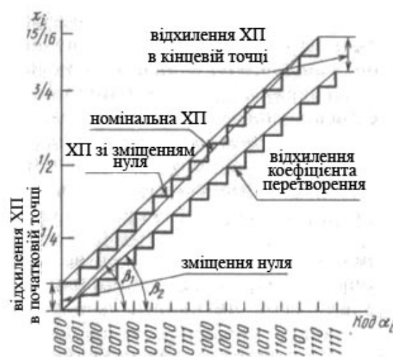
Рисунку 4.6 – Характеристики перетворення ЦАП з відхиленнями в початковій та кінцевої точках:
