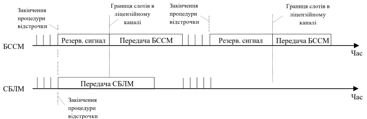
Рисунок 1.2 - Приклад реалізації методу доступу LBT з резервуючим сигналом
