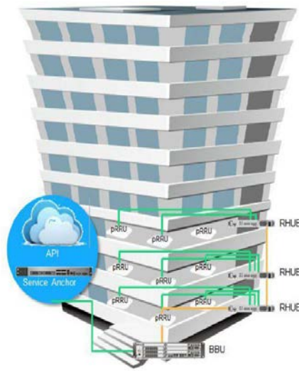
Рисунок 1.6 – Схема з'єднання мережі Indoor
