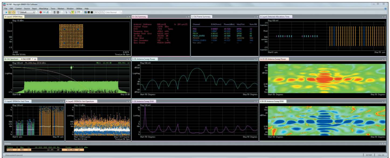
Рисунок 2.2 – Аналіз сигналів стандарту 5G NR з модуляцією 256 QAM та діаграми спрямованості антени
