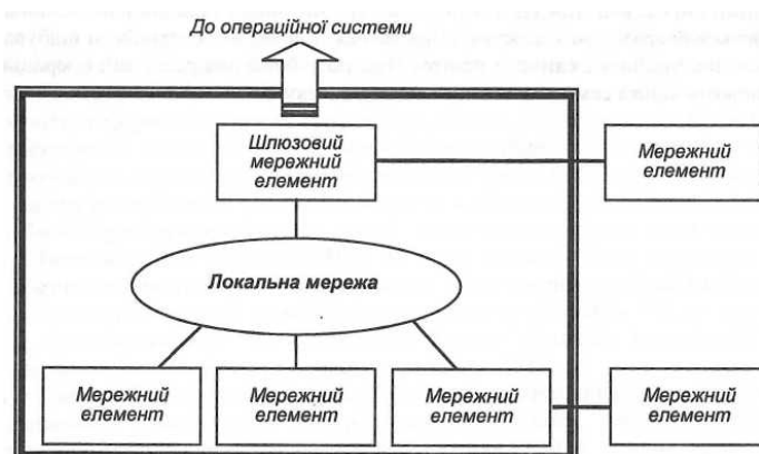
Рисунок 2.7 – Схема організації керуючих зв’язків через локальну мережу (товста лінія - тракт синхронної цифрової ієрархії; тонка - влаштований канал передавання даних)
