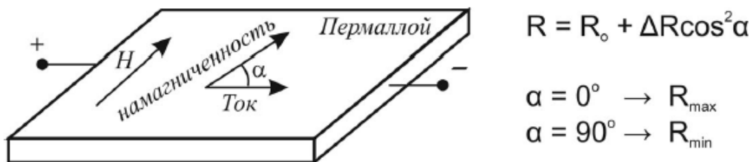
Рисунок 1.17 – Магнітрезисторний датчик на основі пермаллою
