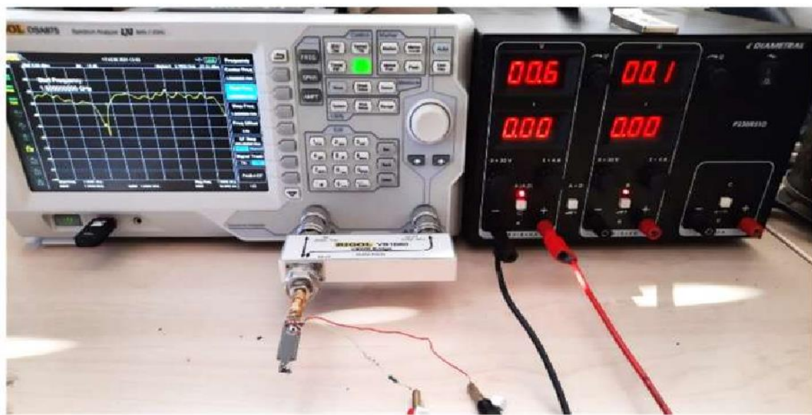
Рисунок 5 - Вимірювання параметрів S11 з різними напругами зміщення
