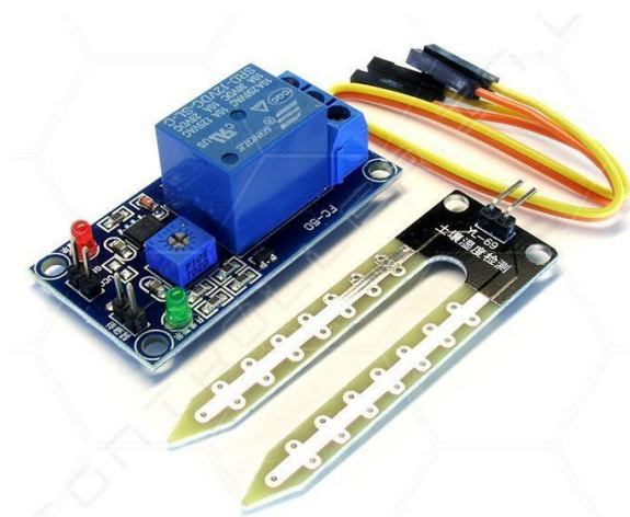
Рисунок 2.5 - Модуль вимірювання ґрунту або різних сипучих матеріалів
