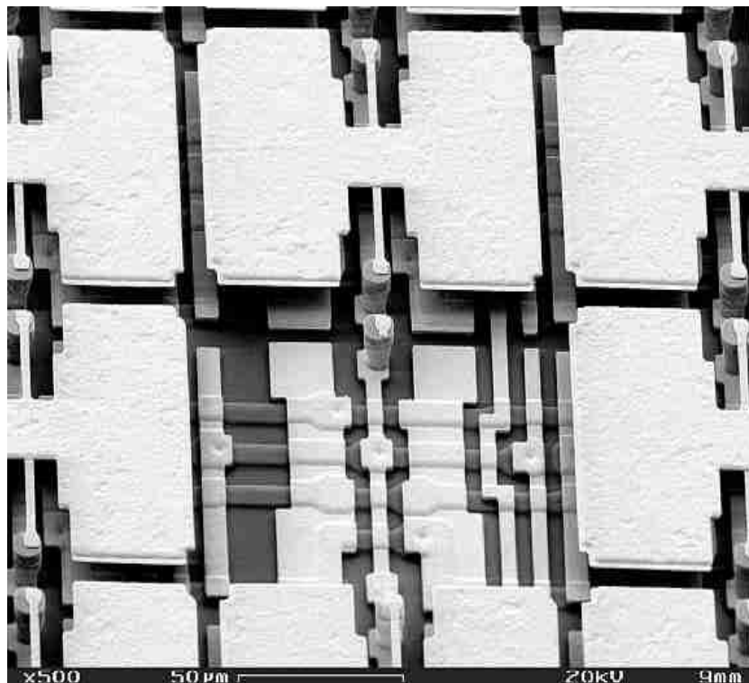
Рисунок 1.31 – Мікродзеркальна матриця розробки Фраунгоферівського інституту напівпровідникових технологій
