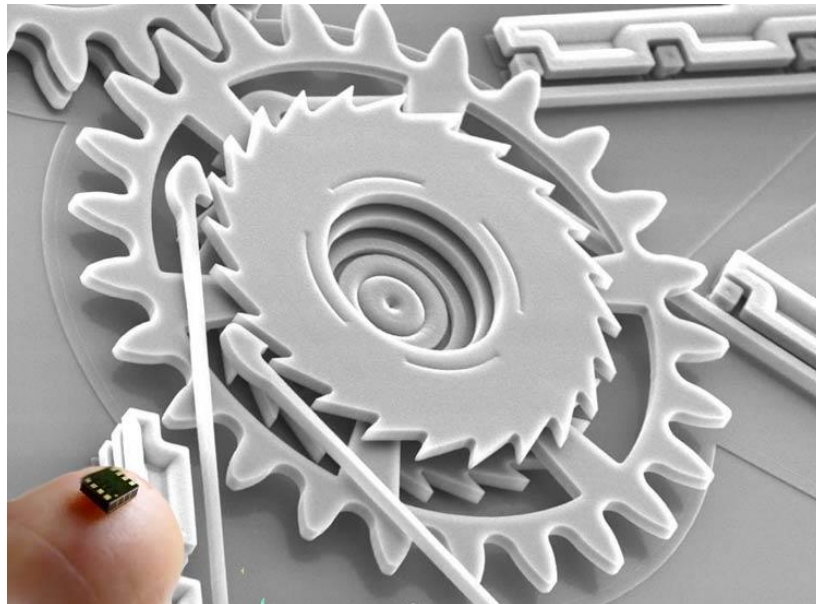
Рисунок 1.1 – Мікрофотографія MEMS структури
