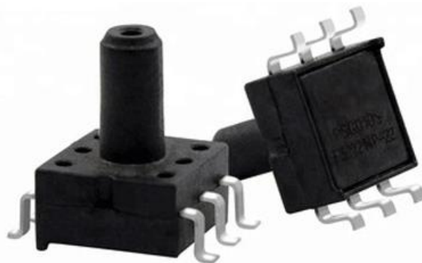
Рисунок 1.16 – Сенсори тиску в мікрокорпусах
