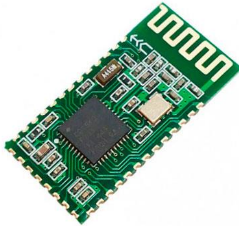
Рисунок 1.7 – Приймально-передавальний модуль HC-08 побудований на мікросхемі CC2540
