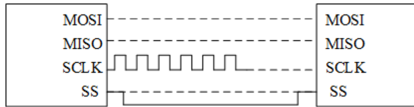
Рисунок 2.13 - Переведення контакту SS в низький логічний рівень
