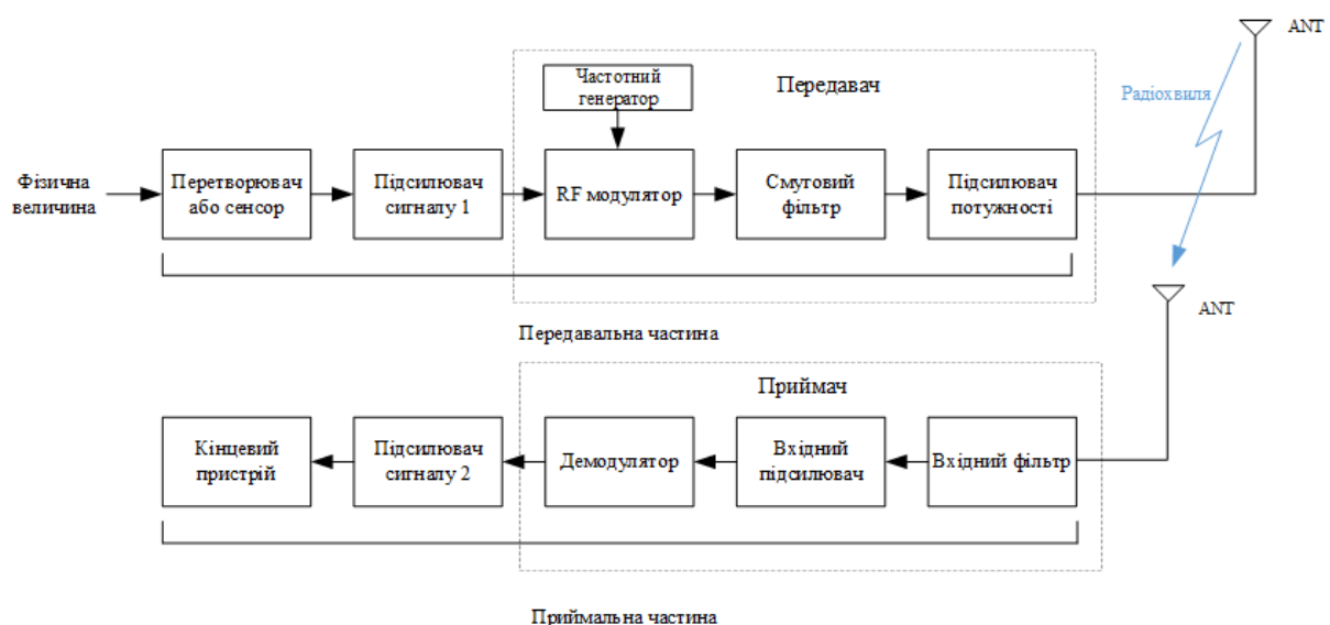
Рисунок 1.2 - Базова структура радіо телеметричної системи
