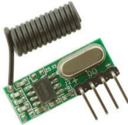
Рисунок 1.6 – Радіочастотний приймач на мікросхемі SYN470R
