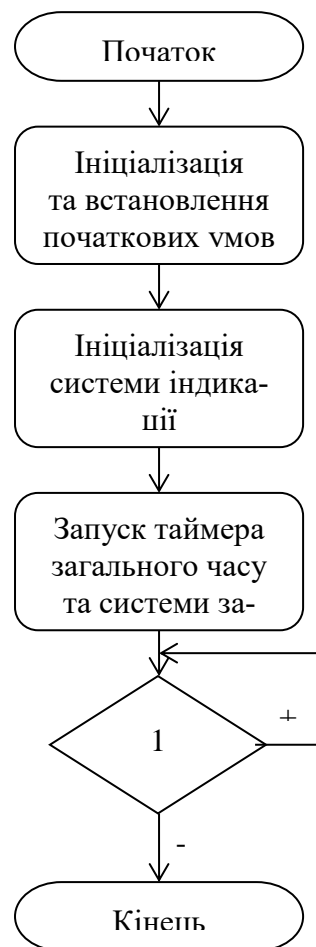
Рисунок 2.6 – Алгоритм головної програми мікроконтролера швидкодіючого частотоміра, модель якого розробляється
