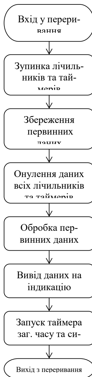
Рисунок 2.7 – Алгоритм переривання таймера загального часу після переповнення
