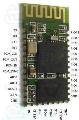
Рисунок 2.12 – Призначення виводів Bluetooth -модуля HC- 04
