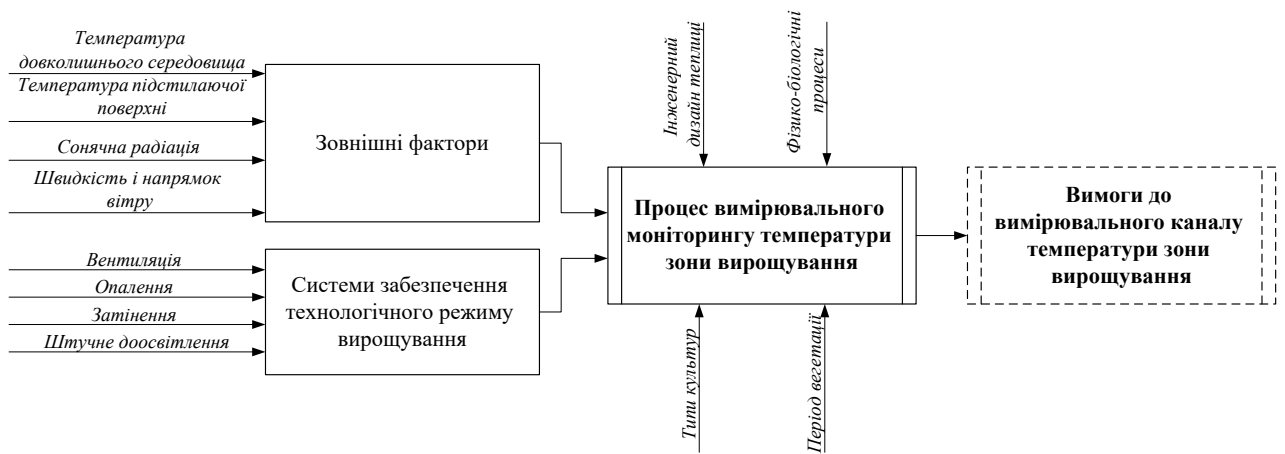
Рисунок 3.1 – Структурна схема моніторингу температури зони вирощування
