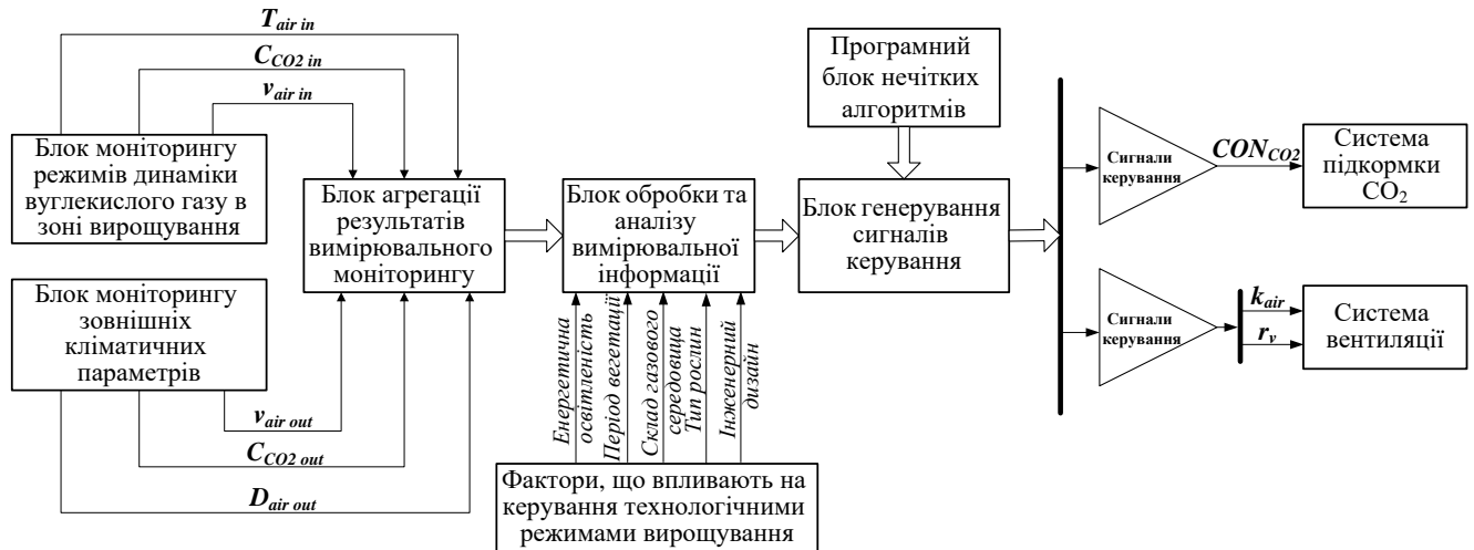
Рисунок 3.22 – Уточнена функціональна схема процедури вимірювального моніторингу концентрації вуглекислого газу під час вирощування
