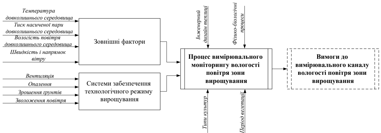
Рисунок 3 – Структурна схема моніторингу вологості повітря теплиці
