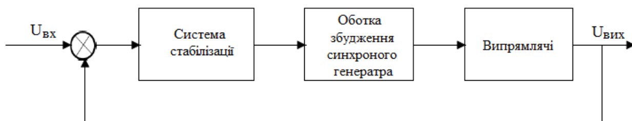
Рисунок 4.11 – Функціональна схема системи стабілізації вихідної напруги
