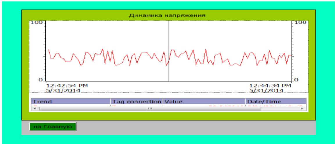
Рисунок 3.4 – Динаміка напруги на виході випрямляча
