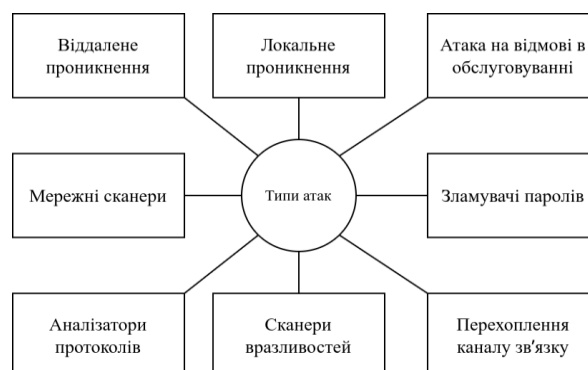
Рисунок 1.2 – Типи атак, які виявляє SIEM
