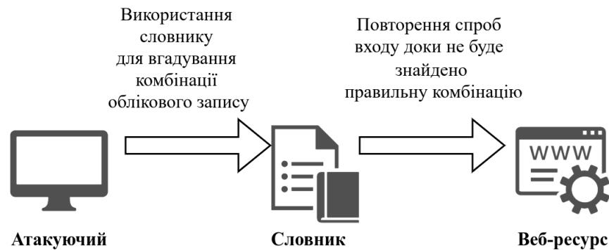
Рисунок 2.7 — Схема роботи атаки грубої сили
