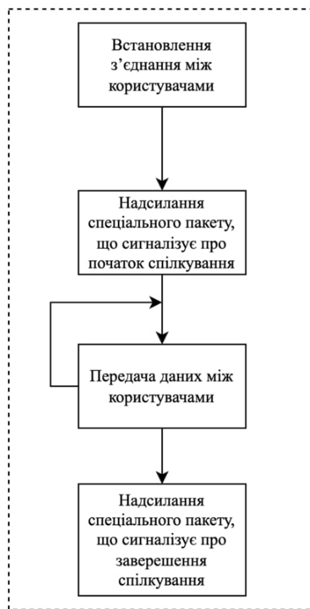
Рисунок 2.6 – Схема процесу передачі даних
