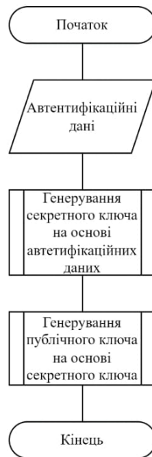
Рисунок 2.11 – Загальний алгоритм генерування ключів шифрування
