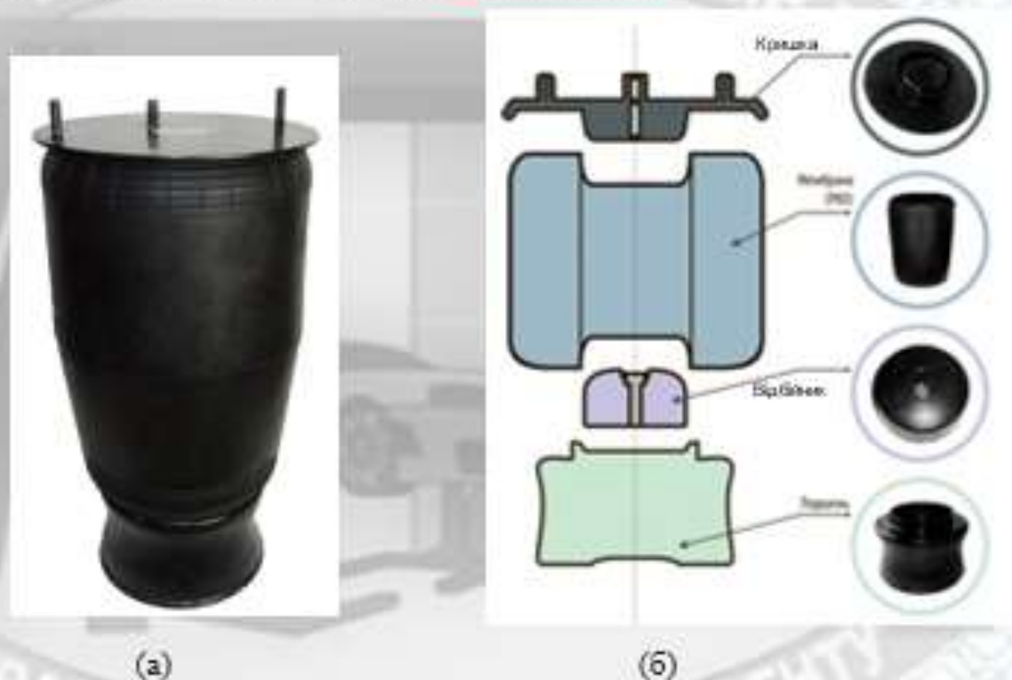
Рисунок 4.3 – Вигляд (а) та схема (б) пневмобалону у зборі автобуса «БОГДАН А701»
