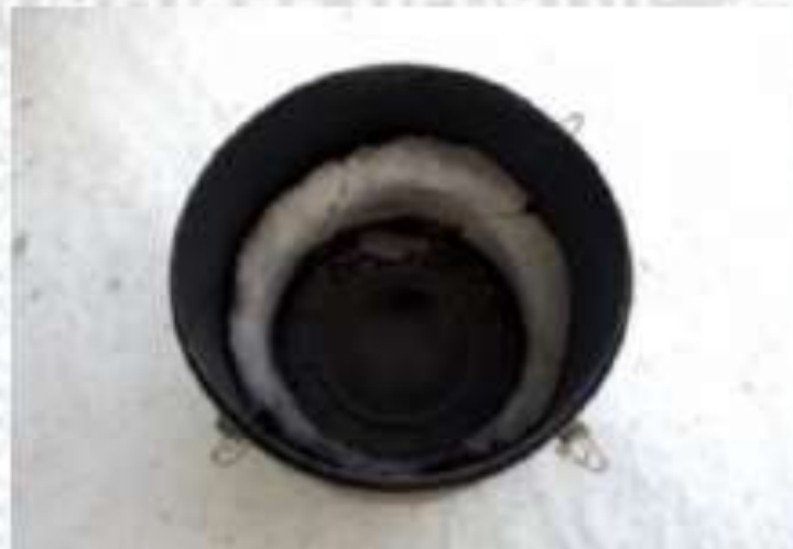
Рисунок 3.4 – Утворення налипання снігу та обледеніння із залишками снігу та льоду в захисному кожусі пневмобалона автобуса «БОГДАН А701»
