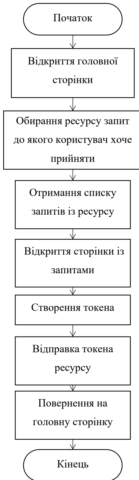
Рисунок 3.7 – Алгоритм прийняття запиту на отримання токена
