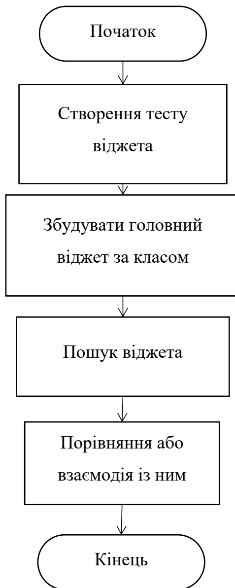
Рисунок 4.3 – Алгоритм тестування віджета
