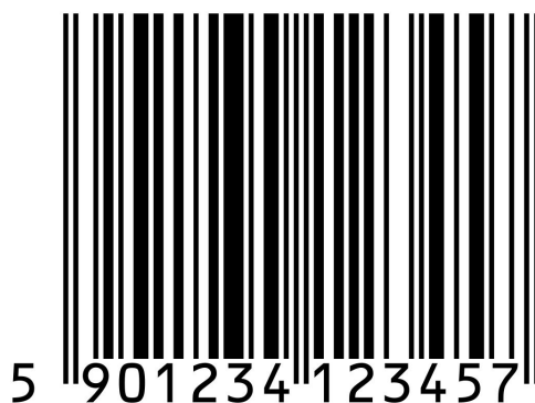
Рисунок 2.2 – Приклад EAN-13 коду
