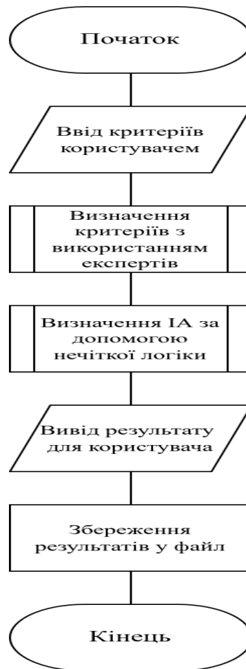
Рисунок 3.5 – Блок-схема роботи програми
