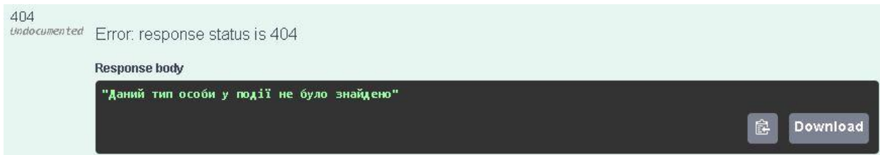
Рисунок 4.20 – Відповідь маршруту POST «incidents», якщо додати подію з реєстраційним номером, який вже є в базі
