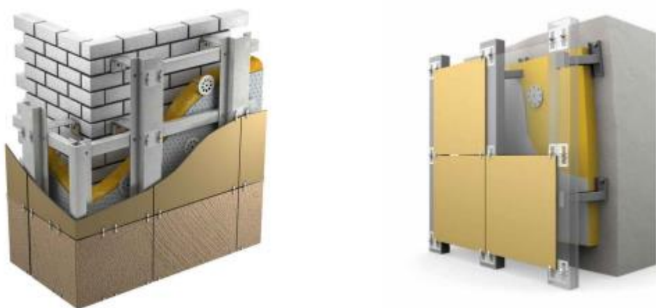
Рисунок 4.1 - Конструкція вентильованого фасаду
