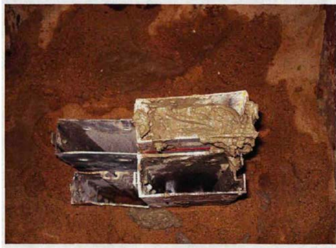
Рис. 3.2 - Профільювальні блоки, занурені в ґрунт.
