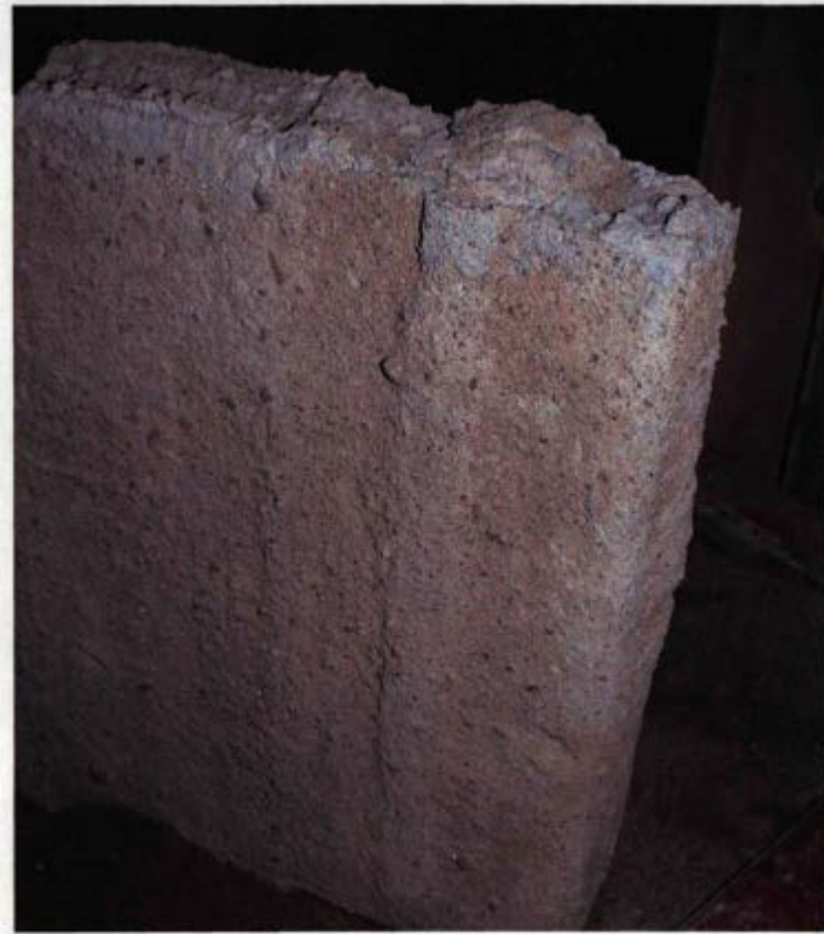
Рис.3.9 - Відформована гідроізолювана бетонна стіна в ґрунті, отримана без втрамбування бетону в ґрунт.
