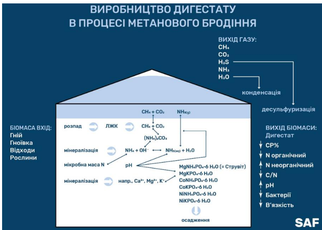
Рисунок 3.6 – Виробництво дигестату під час метанового бродіння.
