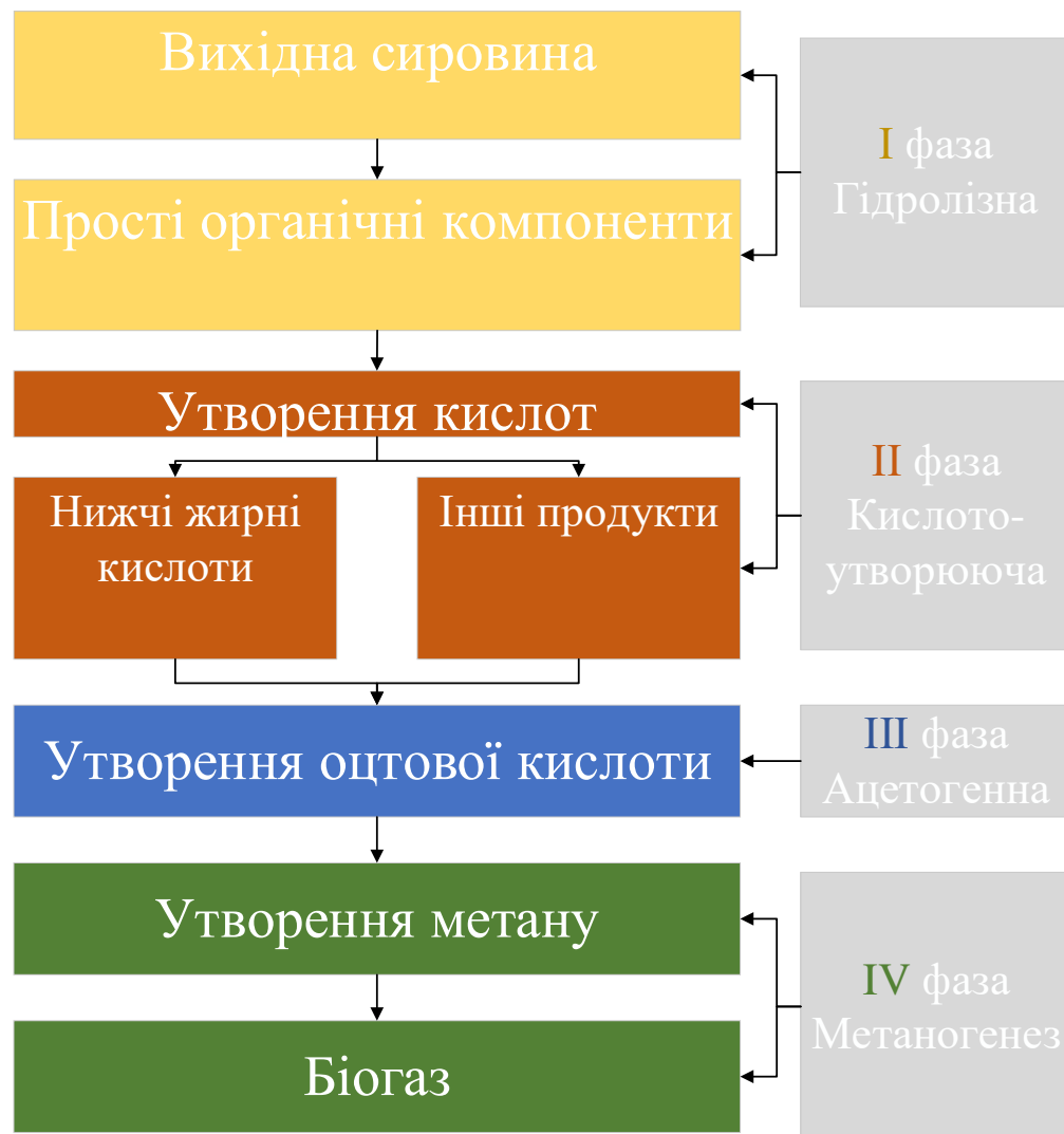
Рисунок 3.1 - Розкладання аеробних бактерій зображене блок-схемою
