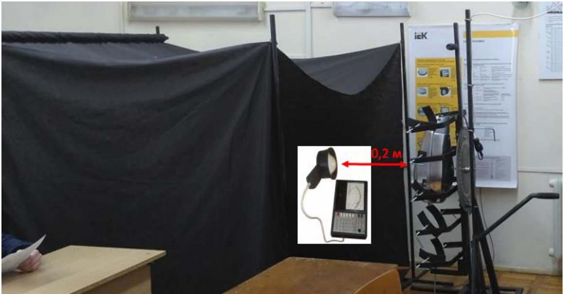
Рисунок 3.1 – Вимірювання освітленості при відстані світильника 0,2 метра
