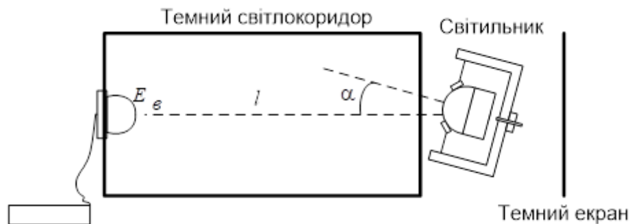
Рисунок 1.14 – Схема установки для вимірювання світлотехнічних характеристик світильників
