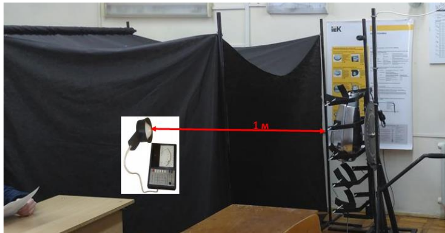
Рисунок 3.4 – Вимірювання освітленості при відстані світильника 1 метра
