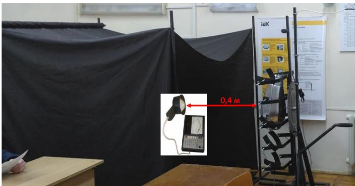
Рисунок 3.2 – Вимірювання освітленості при відстані світильника 0,4 метра
