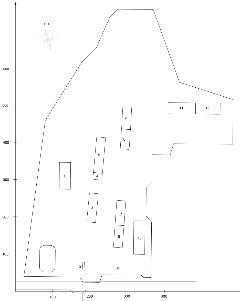
Рисунок 1.1 – Генеральний план комплексу первинної обробки та накопичення зерна ТОВ «Хмільницьке»
