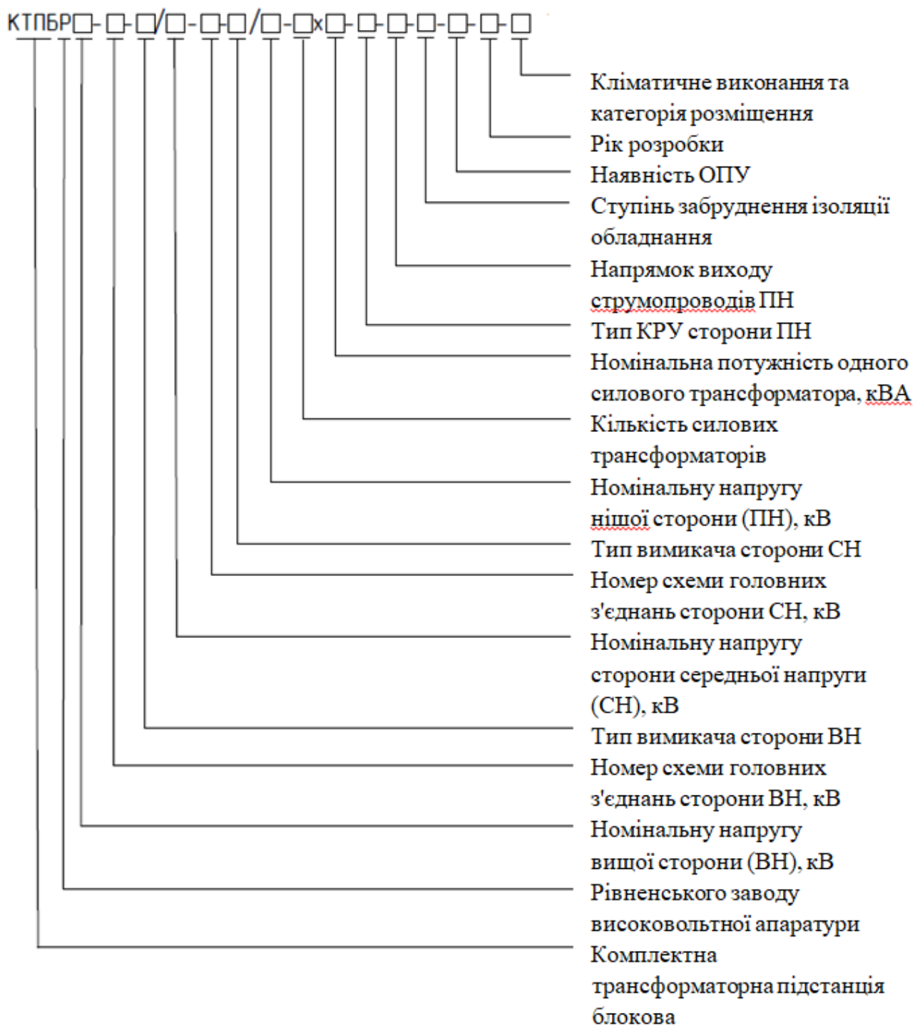
Рисунок 2.2 – Умовне позначення КТПБР та його розшифровка
