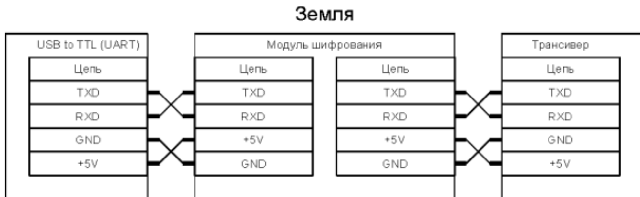
Рисунок 2.14 —Схематичне зображення підключення шифратора в розрив між наземною станцією і трансивером
