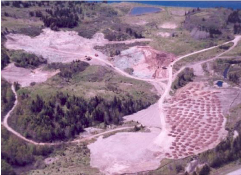
Рисунок 1.6 – Фото проекту рекультивації, приблизно червень 2004 р. Ділянки 2, 3 і 4 (на задньому плані) завершені та засіяні.
