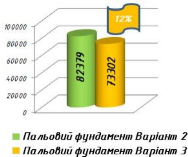
Рисунок 3.11 - Витрати арматури на пальовий ростверк з наявністю деформаційних швів, та їх відсутністю
