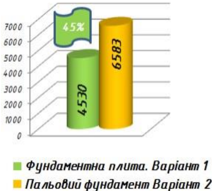
Рисунок 3.6 Витрати бетону на фундаментну плиту та пальовий ростверк з палями
