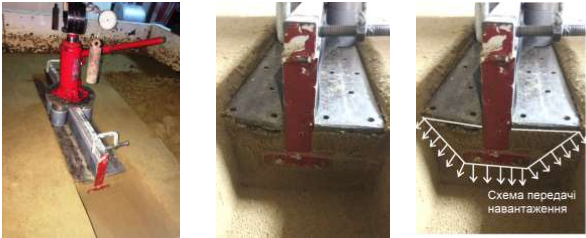
Рис. 2.13 – Робота фундаменту з армованою зворотною засипкою
