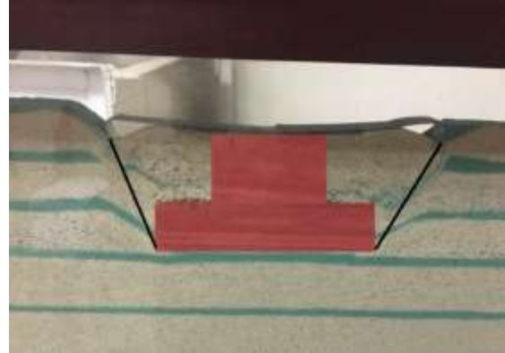
Рис. 2.3 - Випробування моделі фундаменту: а) – без армування зворотної засипки; б) – з армуванням зворотної засипки
