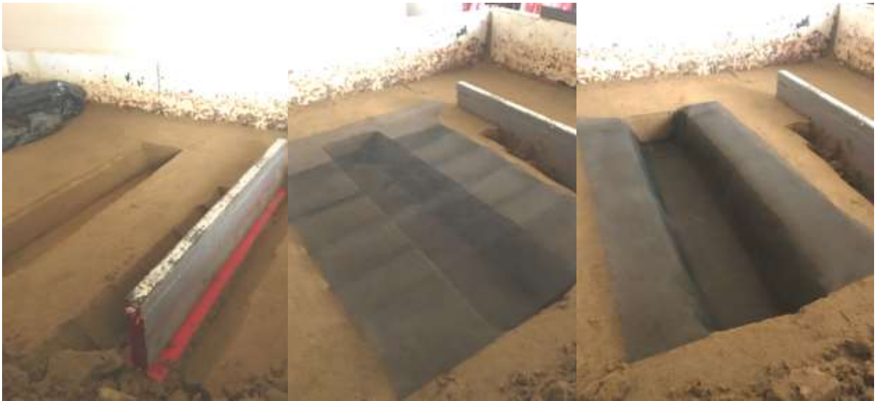
Рис. 2.10 – Укладання геотекстилю для створення схеми проведення випробувань
