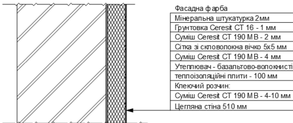
Рисунок 1.1 – Розрахункова конструкція стіни
