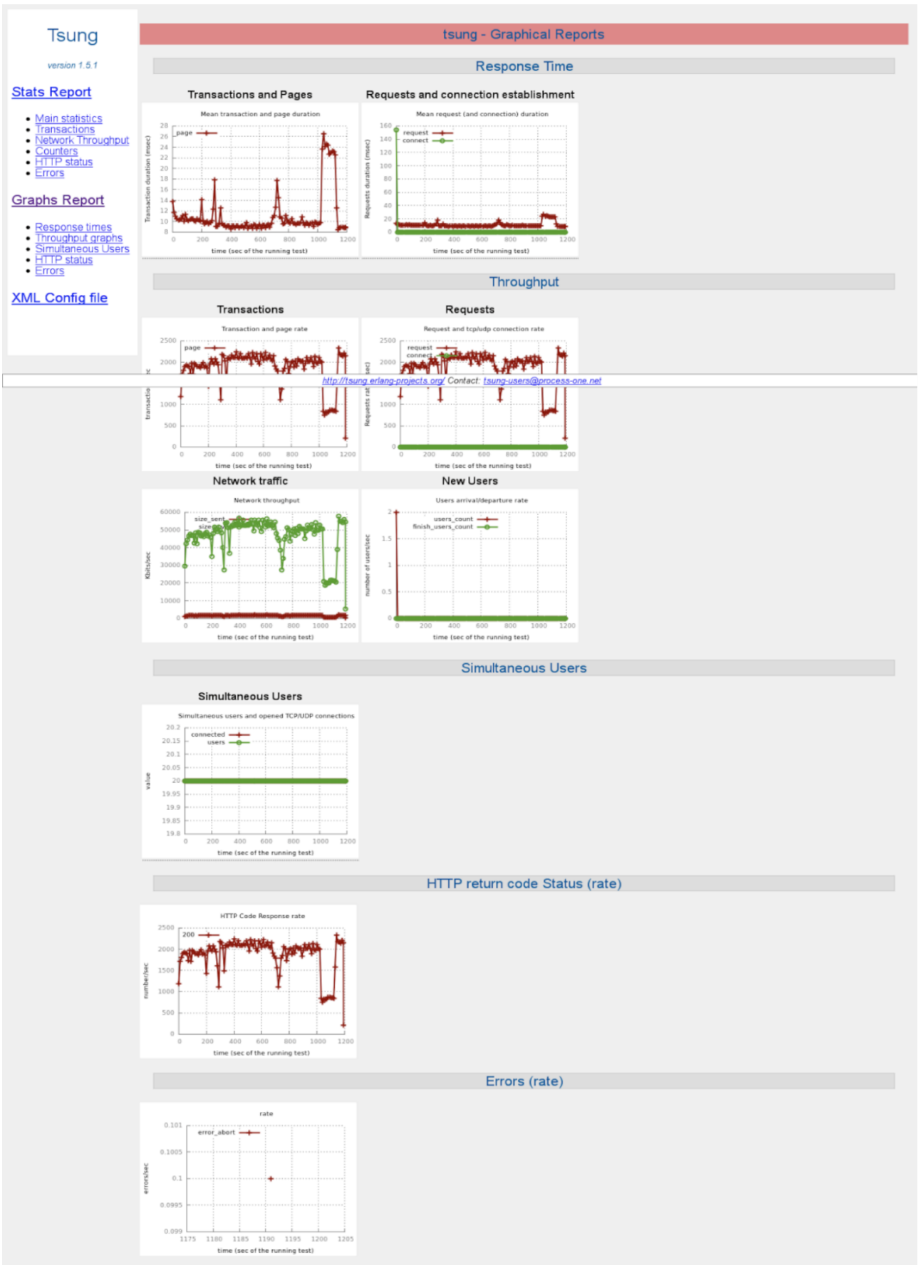
Рисунок 3.8 — Графічний звіт навантажувального тестування
