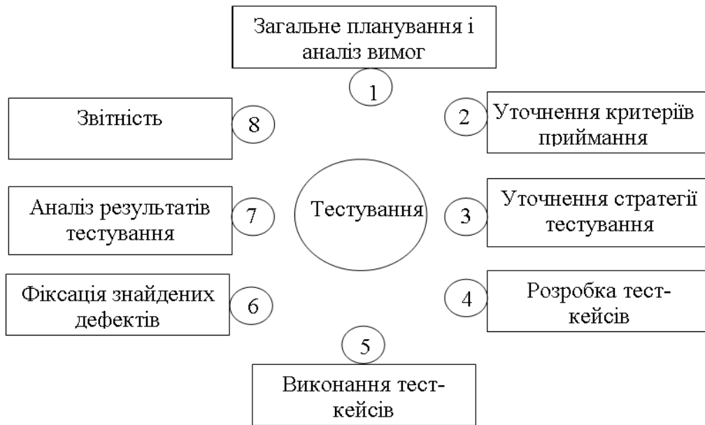
Рисунок Б1 — Життєвий цикл тестування
