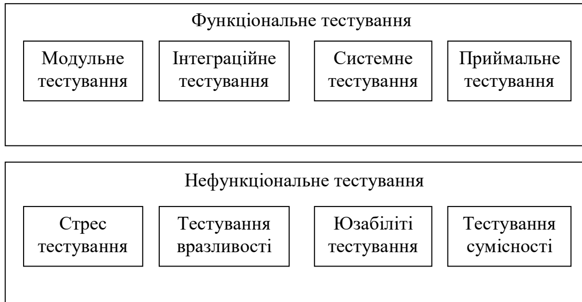
Рисунок 1.2 — Загальна схема основних видів тестування
