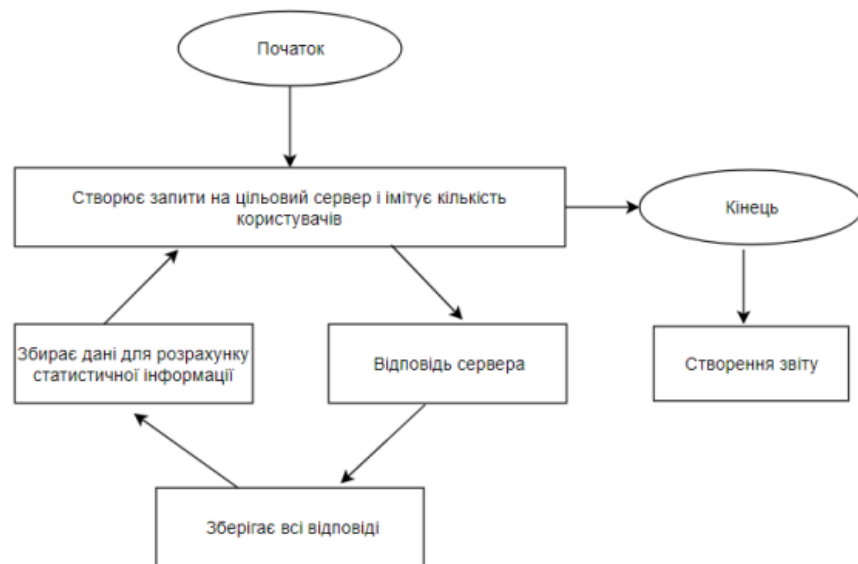
Рисунок 4.1 — Алгоритм роботи Jmeter
