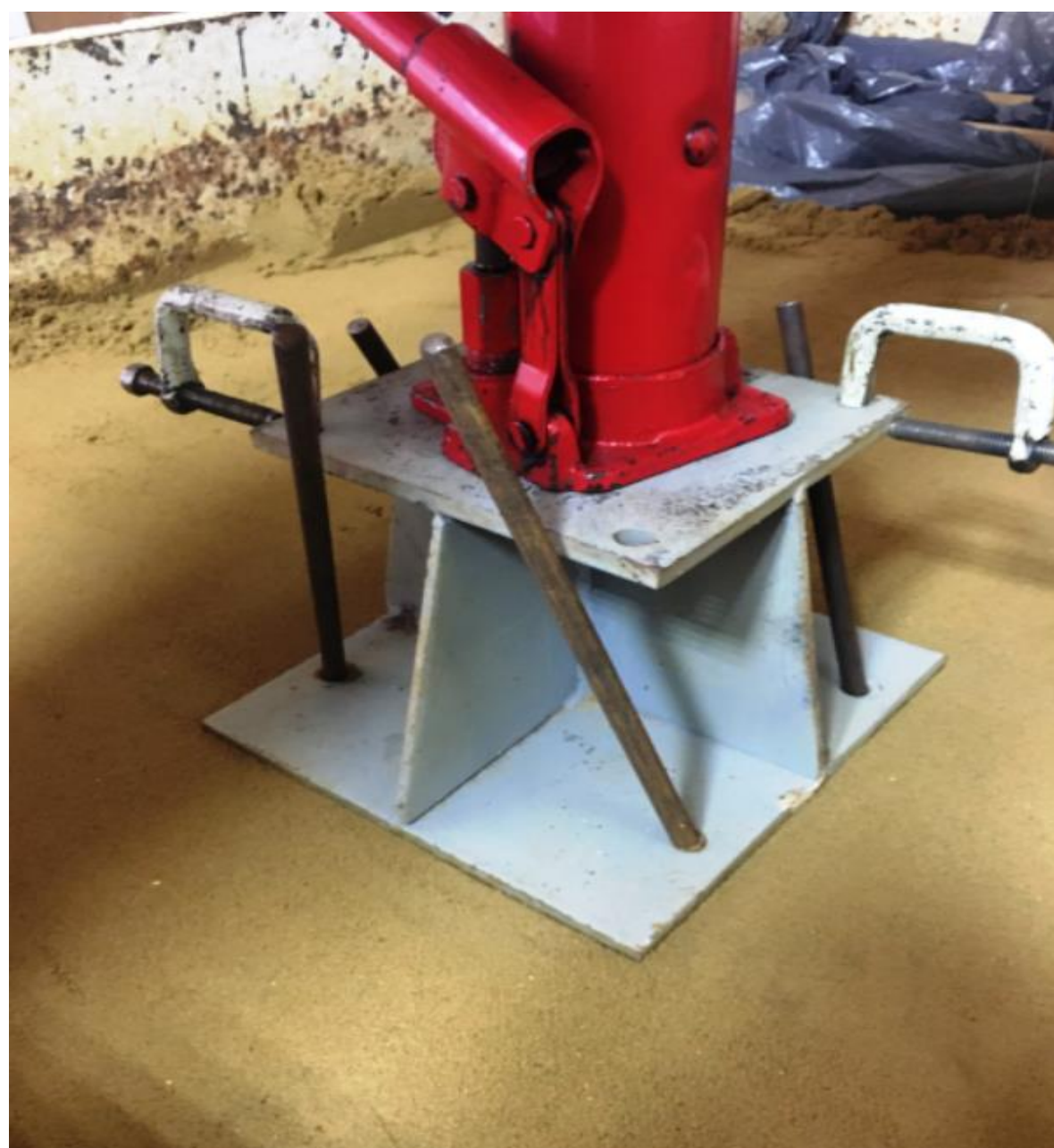
Встановлення елементів підсилення
