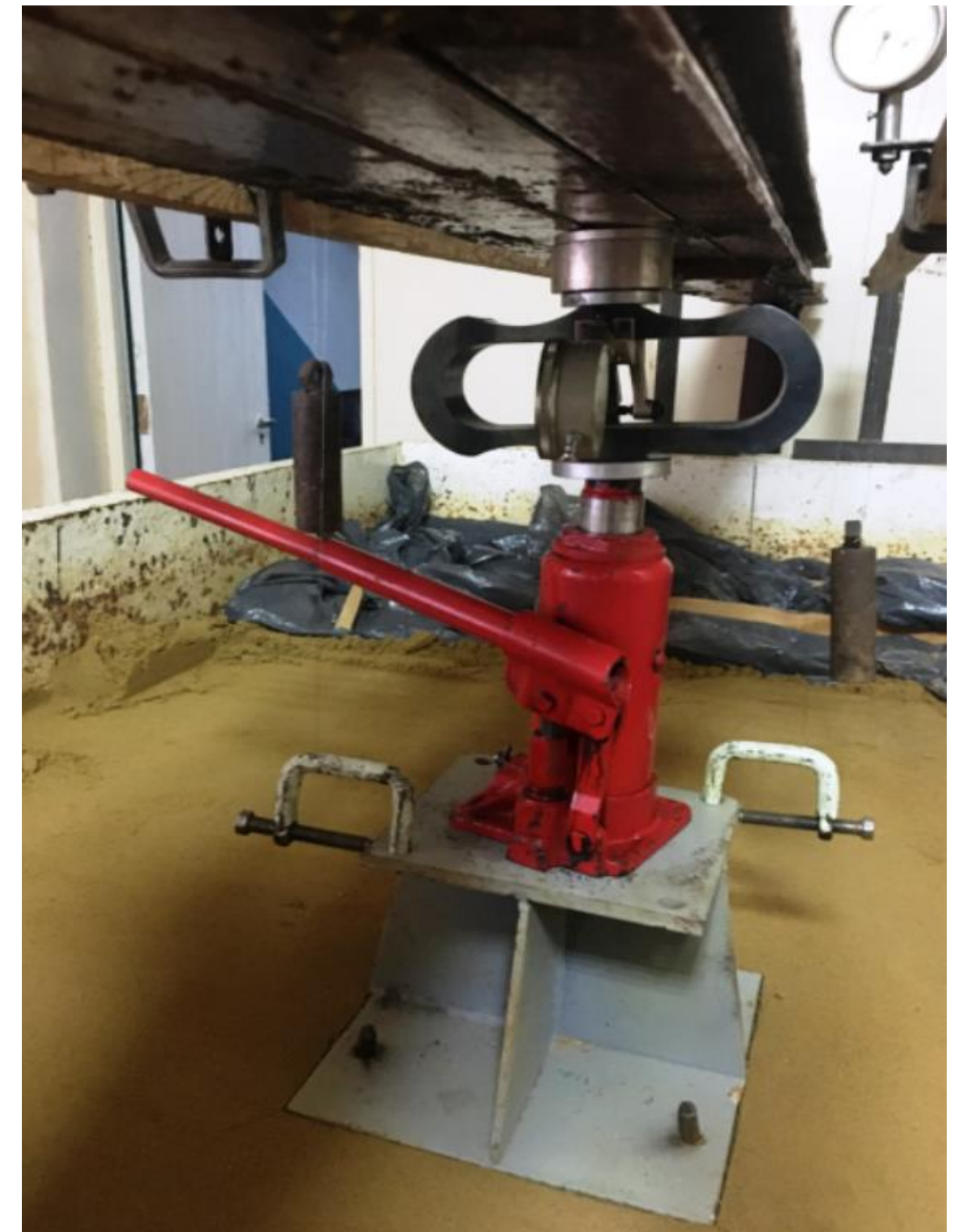
Випробування підсиленого фундаменту
