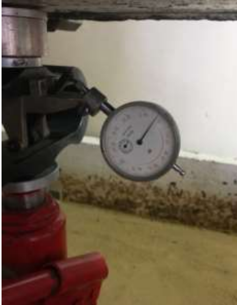
Рис. 2.5 Контроль: а) – навантаження; б) - осідання
