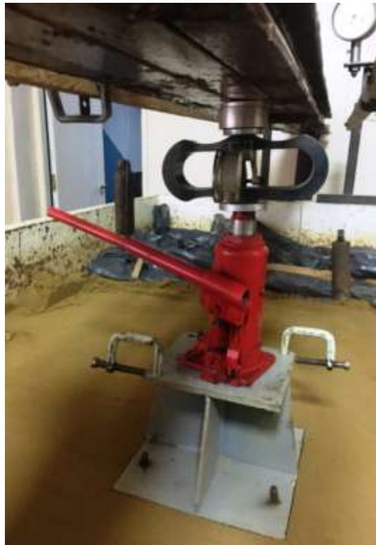
Рис. 2.7 – Випробування підсиленого фундаменту
