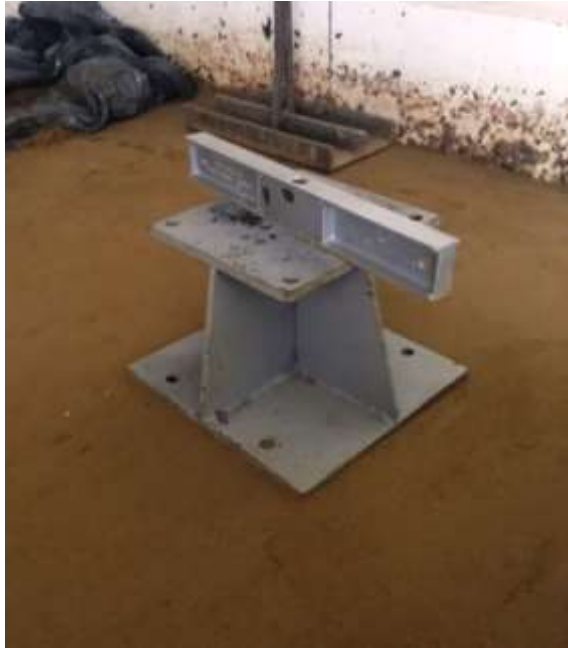
Рис. 2.3 – Контроль положення моделі фундаменту
